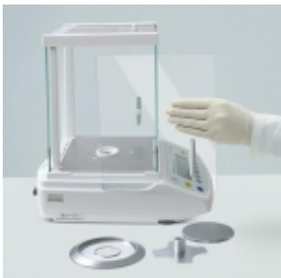
快速清洁、坚固的设计：分析天平防风罩两侧和顶部的防风门，以及称量室内所有不锈钢零件都能轻松取下，方便进行彻底清洁。
