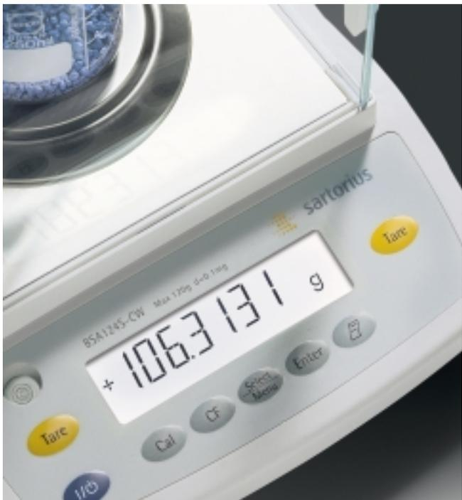
高对比度带背景光显示屏，让您得到卓越的读数(字符高度：15 mm)。
